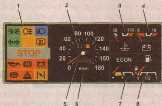
Рис. 63 Щиток приборов 1 - контрольные лампы; 2 - суточный счетчик пройденного пути; 3 - указатель температуры охлаждающей жидкости; 4 - вольтметр; 5 - счетчик пройденного пути; 6 - спидометр; 7 - эконометр; 8 - указатель уровня топлива
